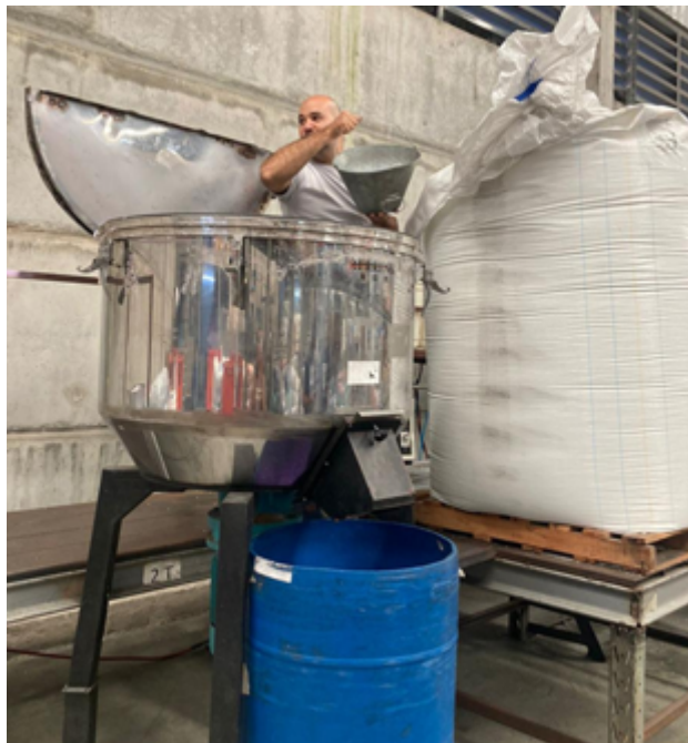
Figura 3 – Abastecimento do misturador de forma manual
